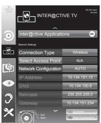
3 Select »Connection Type« with »V« or »A« and then select »Wireless« with »«« or »»«.
